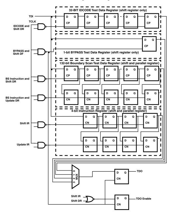
FIGURE 1. GENERAL TEST DATA AND INSTRUCTION REGISTER CONFIGURATION
